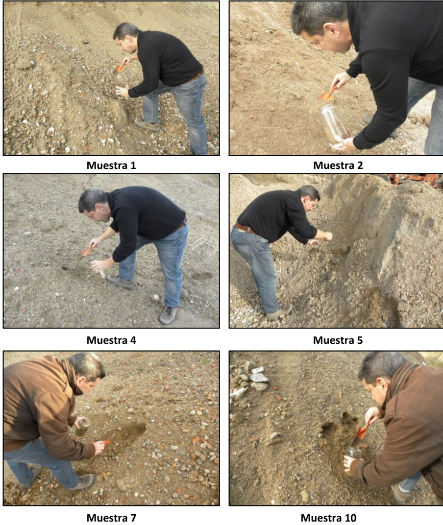
Figura 5. Toma de muestras de material de rechazo (precibado) mixto-cerámico para determinación de contenidos totales de parámetros orgánicos (BTEX, PCB, aceites minerales y HPA)
