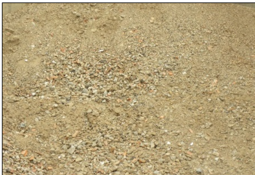
Figura 19. Residuo del precibado de finos de RCD mixto-cerámicos (0-40 mm)
