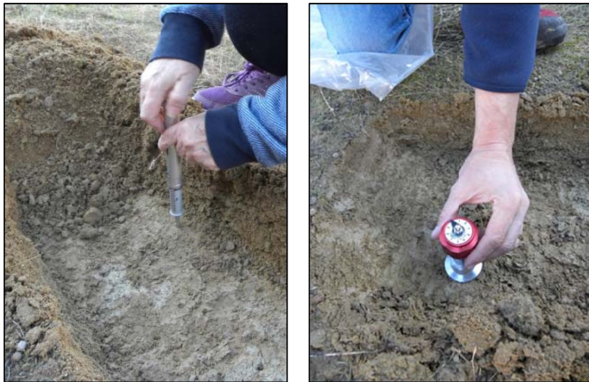
Figura 22. Ensayos de resistencia a la compresión simple con penetrómetro de bolsillo de hasta 5 dNa/cm 2 (izquierda) y de resistencia al corte con vane test (derecha) en condiciones no drenadas.:
