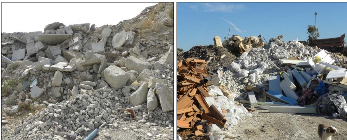
Figura 16. RCD de hormigón (Izq.) y mixto-cerámicos (Dcha.) acopiados en la zona de descarga antes de la separación de elementos reutilizables (plásticos, madera, etc.) y otros elementos contaminantes.
