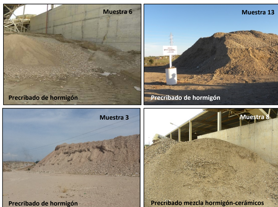
Figura 2. Acopios de material de precibado de hormigón y mezcla hormigón-cerámicos de donde se han recogido muestras para la caracterización de la lixiviabilidad y la realización de otros ensayos.
