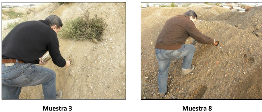
Figura 6. Toma de muestras de material de rechazo (precibado) de hormigón y mezcla hormigón-cerámicos para determinación de parámetros orgánicos (BTEX, PCB, aceites minerales y HPA)
